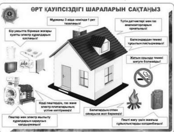
Характерны случаи пожаров в жилых домах от неисправности и неправильной эксплуатации печи. Не всегда проверяются дымовые каналы и дымовые трубы на чердаках. Дымовая труба на чердаке должна быть побелена известковым раствором, без трещин.
